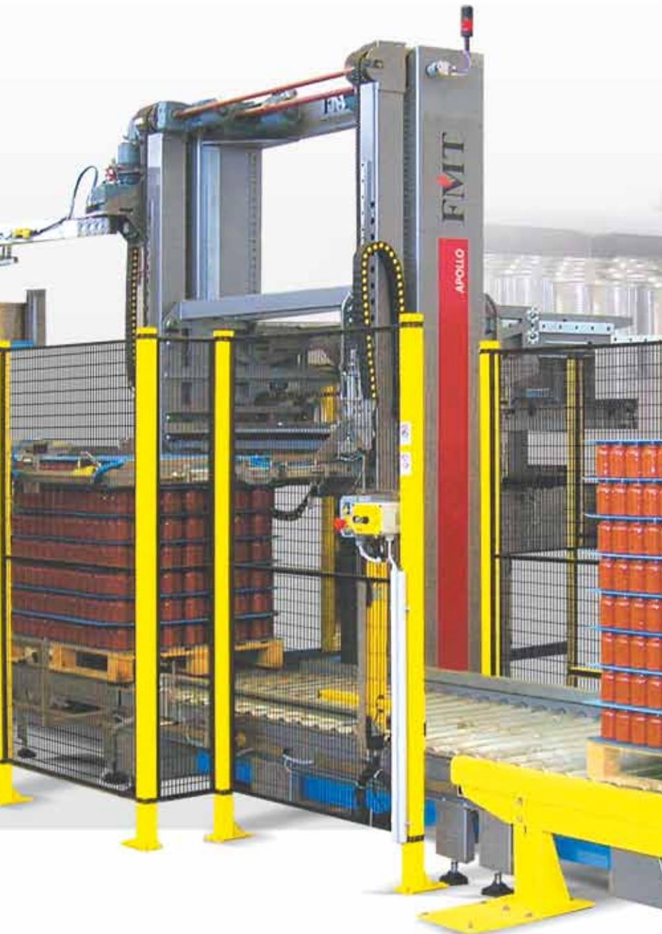
**Les palettiseurs/dépalettiseurs modèle « APOLLO » pour des contenants en vrac sont alimentés par le bas et sont bâtis sur la base d'une structure robuste à deux montants.**
