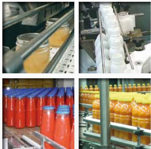
**Les convoyeurs spécialement étudiés pour le transport des boîtes en métal, pots et bouteilles en verre ou plastique, sont conçus sur la base d'une structure robuste, modulaire, en acier inox AISI 304, pouvant être facilement adaptée à toute exigence du client.**
