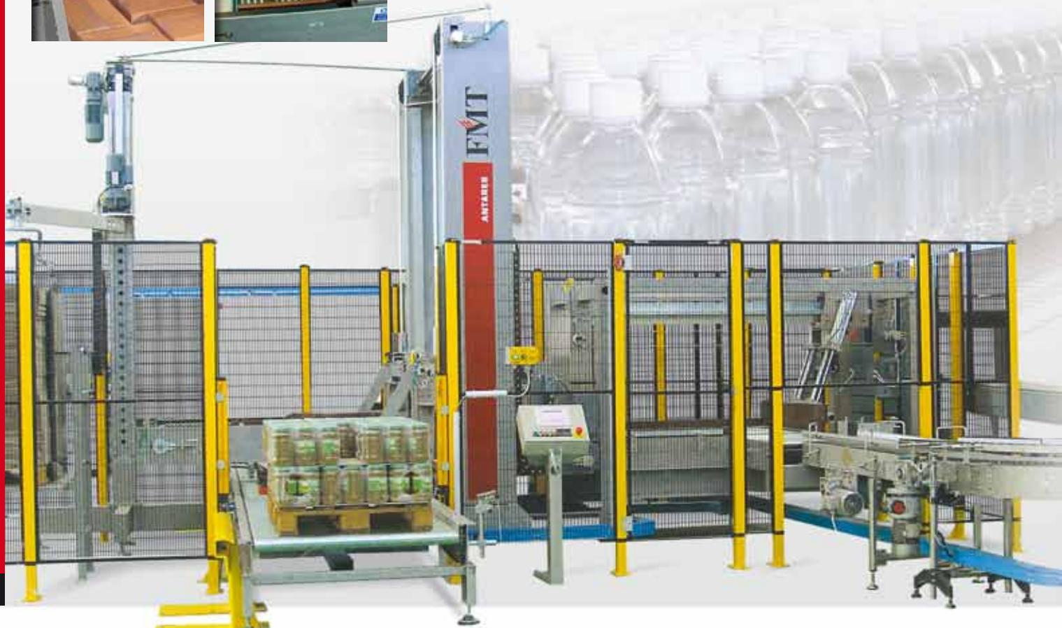
**Les palettiseurs de cartons/fardeaux et caisses modèle “ANTARES”** sont conçus sur la base d'une structure robuste à deux montants. Ils peuvent avoir une ou plusieurs entrées avec transfert du produit sur palette au moyen d'une plateforme à rouleaux pouvant être ouverte en deux moitiés. La plateforme est dotée de guides de centrage motorisés et programmables permettant le parfait centrage sur la palette et un changement de format très rapide.
