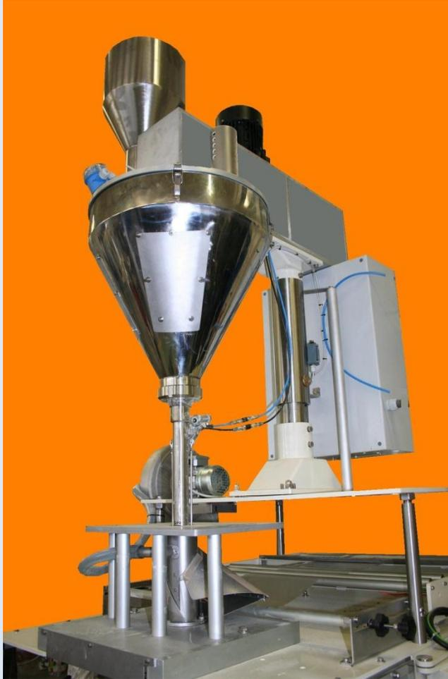
Il dosatore a coclea Miele presenta una serie di accessori/varianti che lo rendono la soluzione ottimale per il dosaggio volumetrico di polveri a scorrimento libero e non, granulati ed altri prodotti secchi.
