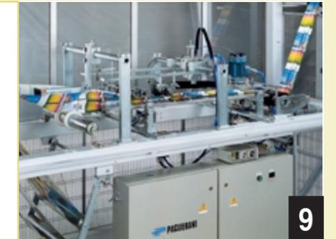
Si l'on utilise un matériau thermosoudable et si l'emballage est compris dans les dimensions 180 x 110 x 440 mm, on peut appliquer la formeuse de sachets. Le système comprend:
