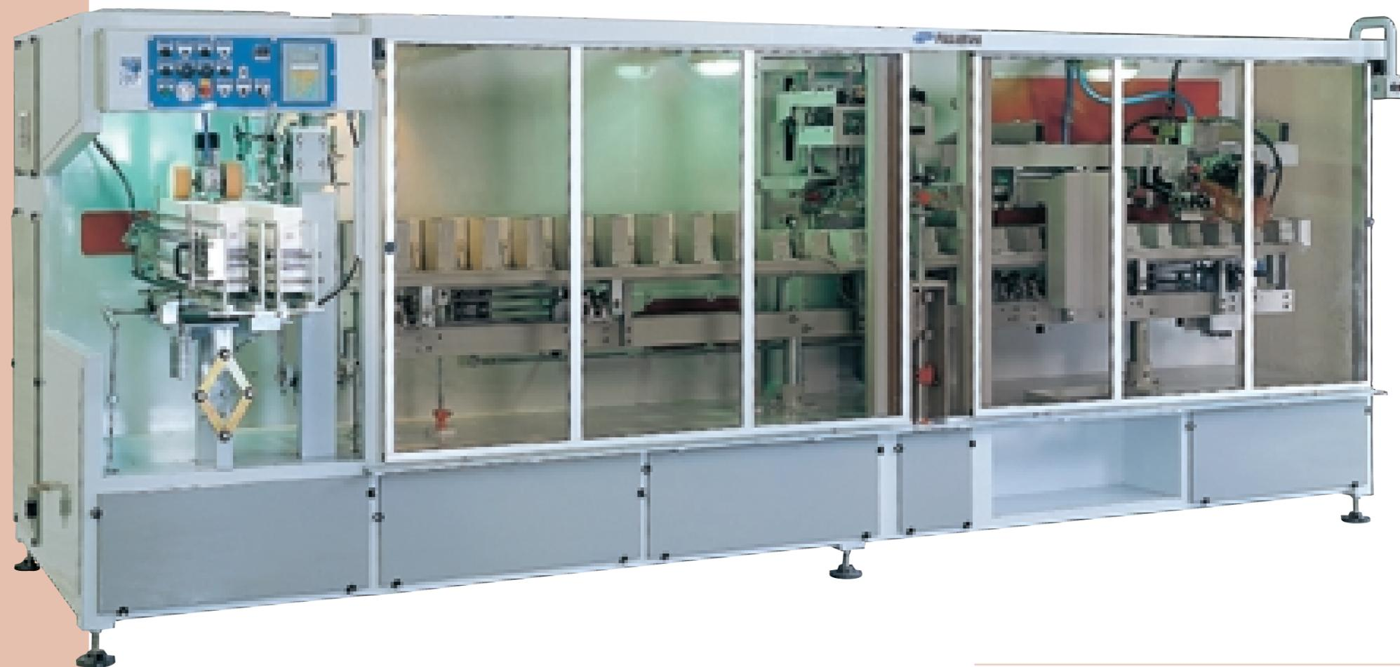
Des performances haut de gamme et une maintenance minimum sont garanties par le fonctionnement entièrement mécanique obtenu par cames, par l'absence de pompes pour le vide et par la minimisation des organes mécaniques.
