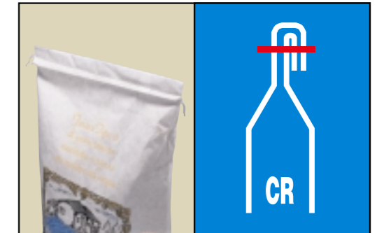
Couture avec pliage (papier, polyéthylène, polypropylène).
