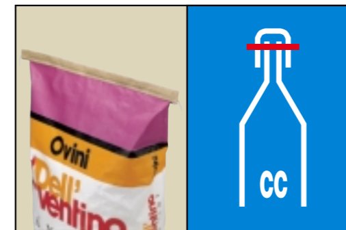
Couture avec application d'un cavalier en bande crêpé (papier).
