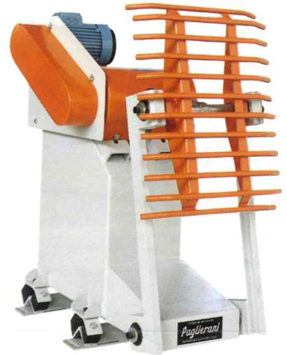
Suivant le modèle de carrousel (V3, V4 ou V6) ainsi que du type de produit à ensacher, un ou plusieurs dispositifs de secouement du sac sont appliqués. Leur fonction est de secouer "latéralement" le sac. L'ampleur de secouement est réglable mécaniquement.
