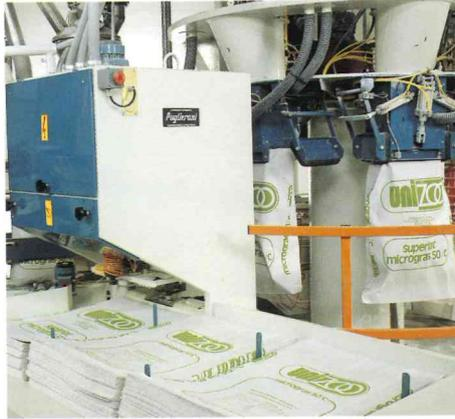
Les trois versions du carrousel d'ensachage peuvent être automatisées (pour la phase de présentation du sac vide) grâce à l'accouplement avec le présentateur automatique de sacs vides modèle FS 358.
