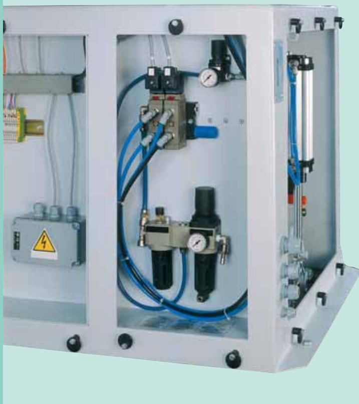
Le poste pneumatique est équipé d'un groupe réducteur de pression, d'un filtre, d'un graisseur et d'électrovannes. Il est placé dans un logement protégé, facilement accessible pour l'entretien.
