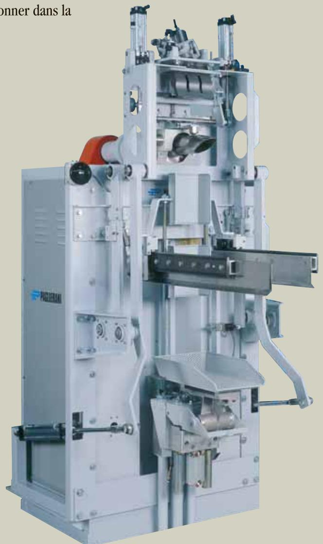
Soudeuse à ultrasons sur ensacheuse SIMPLE A1.
